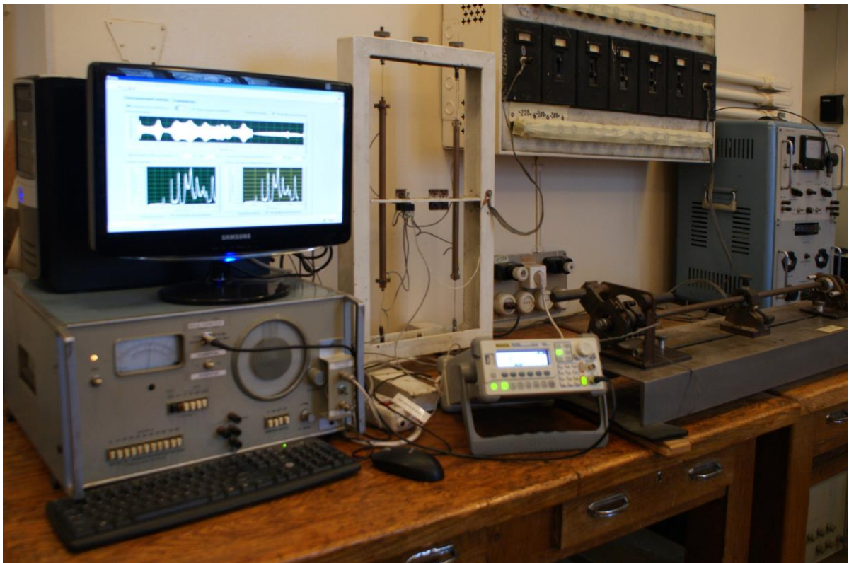
Рис. 3.6. Фотография установки для исследования продольных и крутильных колебаний стержней
