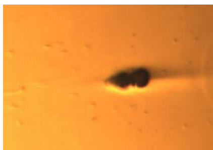
Рис. 9. Визуализация начала кипения в гелевом фантоме ткани с помощью скоростной видеокамеры. Кадр снят через 9 мс после начала облучения. Амплитуда давления на излучателе p_0 = 0.46 МПа.
