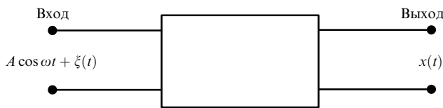
Рис. 4. Принципиальная схема четырёхполюсника.
