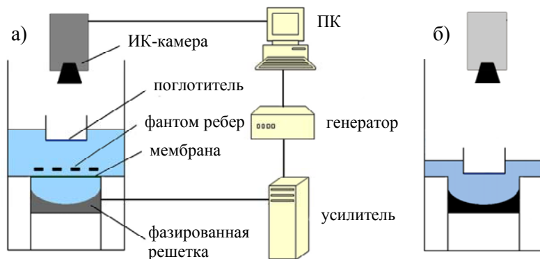
Рис. 7.29. Схема измерений распределений интенсивности: (а) - в фокальной плоскости и (б) - в плоскости ребер (б) с помощью ИК-камеры.
