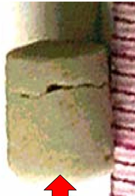
Появление трещины при отражении импульса от задней поверхности камня
