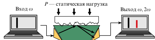
Рис. 3. Схема диагностики шероховатой поверхности на основе генерации гармоник, возникающих благодаря структурной нелинейности.
