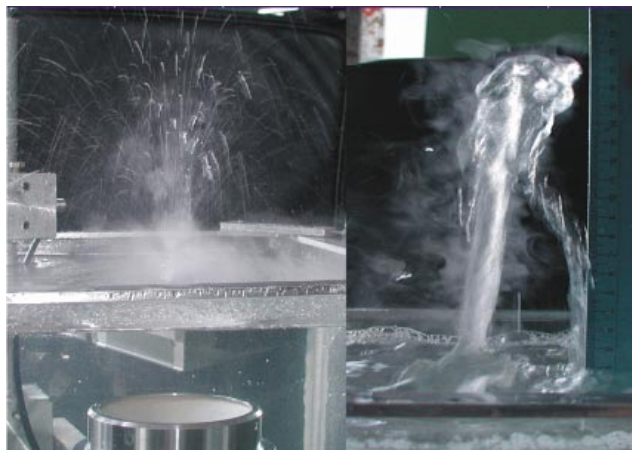
Рис. 12. Образование струи под действием радиационного давления. (Фотография предоставлена О.А. Сапожниковым.)
