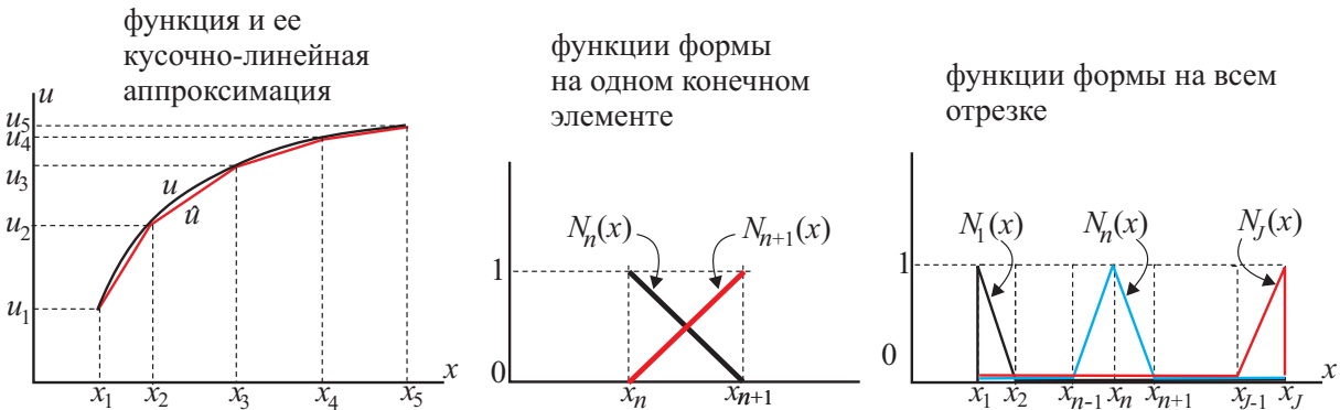
Рис. 2.1: Кусочно-линейная аппроксимация и ее реализация с помощью функций формы
