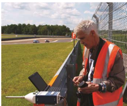
Фото 5. Б.И. Гончаренко проводит измерения шума на гоночной трассе "Moscow Raceway", 2013 г.
