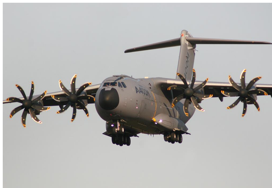
Современный винт с увеличенным числом лопастей и небольшой саблевидностью - самолет А400
