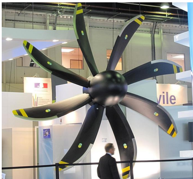
Современный винт с увеличенным числом лопастей и небольшой саблевидностью - самолет А400
