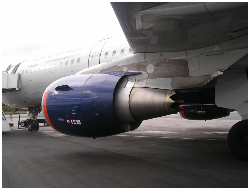
Шевроны за соплом первого контура двигателя CFM-56 самолета А321 «Аэрофлота» (а/п Пулково)
