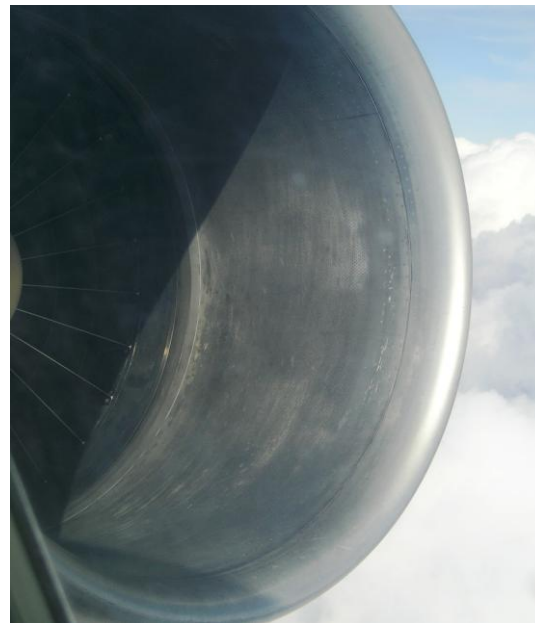
ЗПК в воздухозаборнике (Ту-154М, двигатель Д-30КУ)
