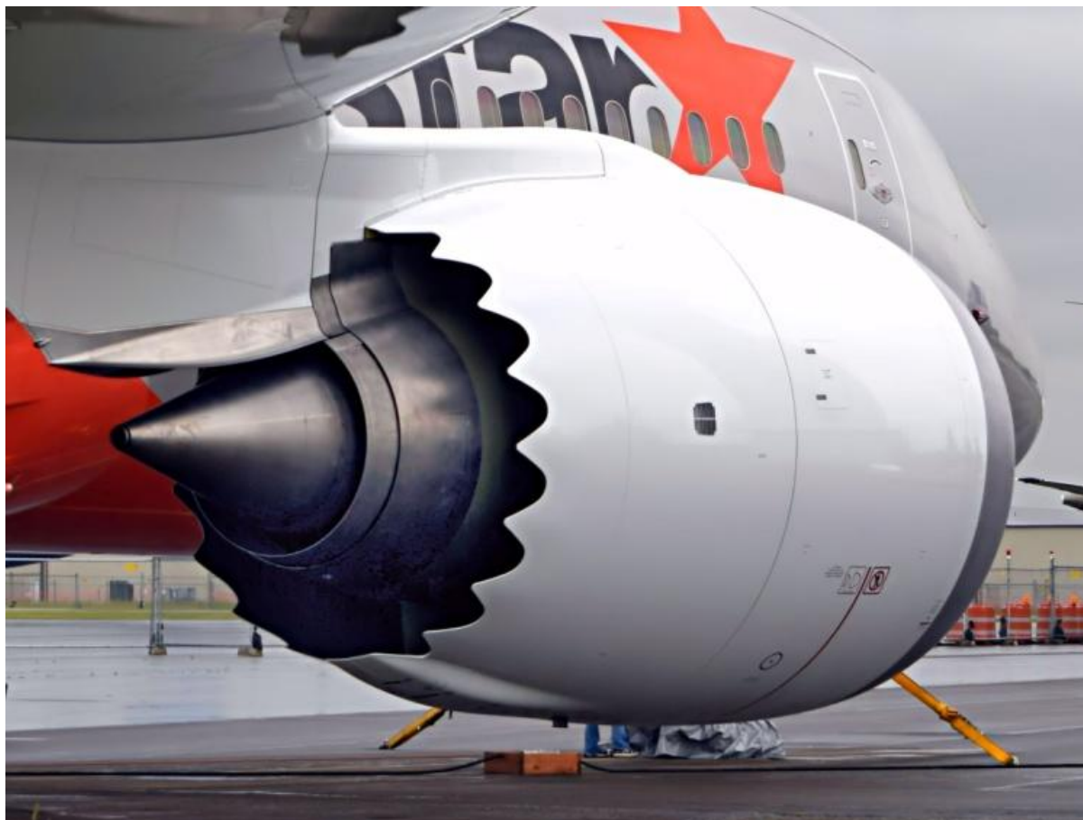
Шевроны на гондole второго контура самолета Boeing-787 'Dreamliner' (двигатель GEnx-1).
