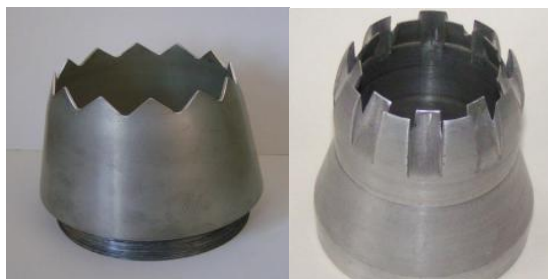
Пилообразная и прямоугольная кромки сопла
