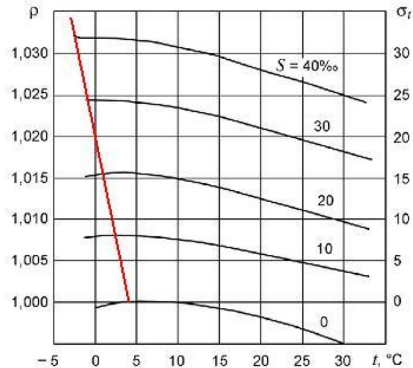
*Плотность воды в зависимости от температуры при разных соленостях.*
