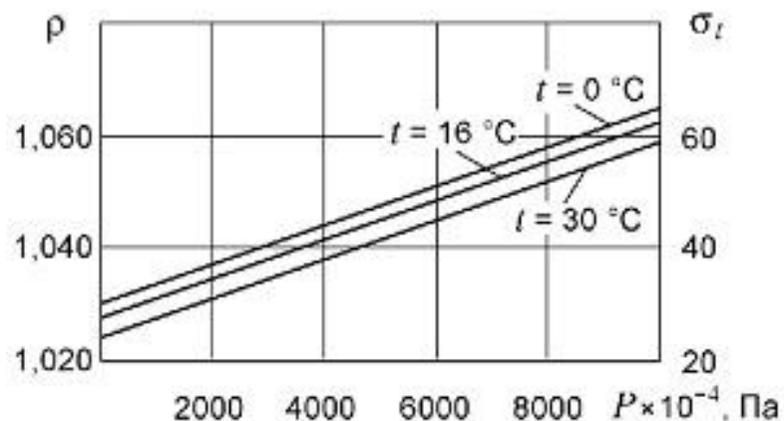
*Зависимость плотности морской воды от давления при различных температурах (при  $s = 35\text{‰}$ )*
