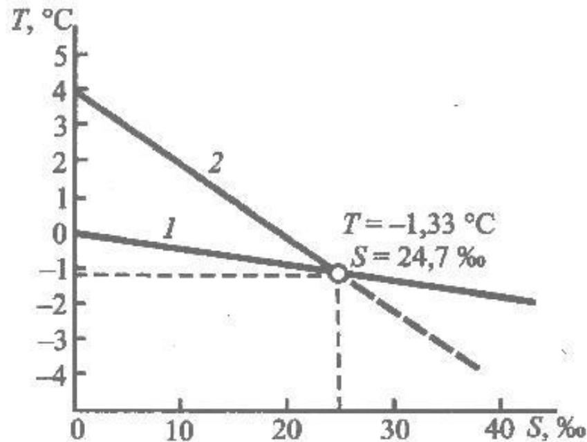
*Температура замерзания (1) и температура максимальной плотности (2) морской воды в зависимости от солености*
