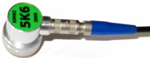
Рис. 2.7. Внешний вид пьезоэлектрического датчика, используемого для возбуждения и приёма продольных волн
