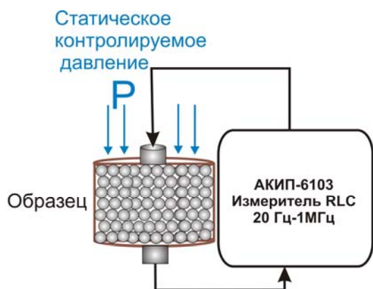
Рис. 11. Схема установки для измерения зависимости электрического сопротивления ГНС от внешнего статического давления
